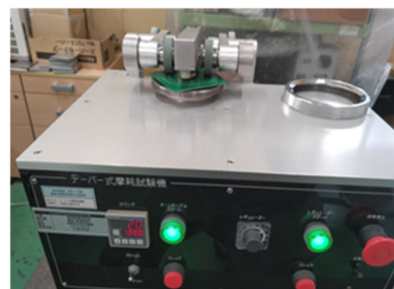
図-2：テーバー摩耗試験機 (摩耗輪 H19, 荷重 500gf、1000 回転)
