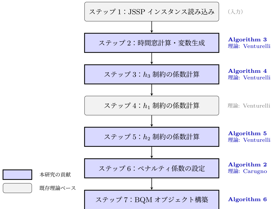
図 5.1 BQM 直接構築の処理フローと各 Algorithm の対応. 青枠（太線）は本研究でアルゴリズムを整理・改善した部分，灰色枠（丸角）は既存理論をそのまま使用する部分を示す．右側に対応する Algorithm 番号と理論の出典を記載した．
