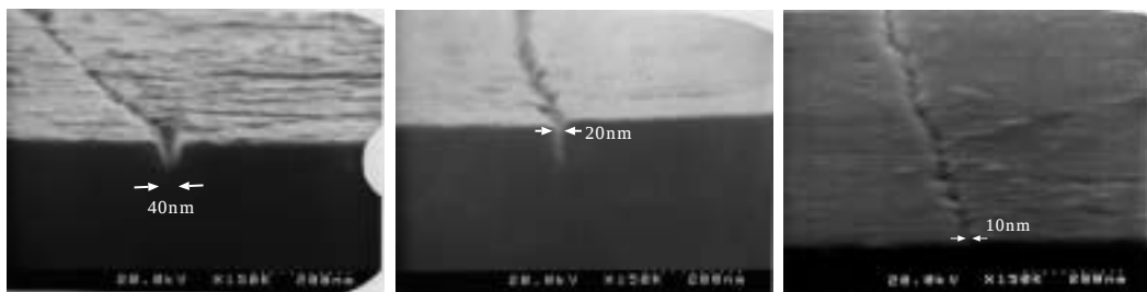
図 2 ナノトレんチの断面 SEM 像
