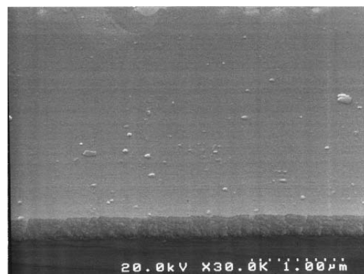
図 2: Si 上に成長した CeO_2 エピ膜の SEM 像
