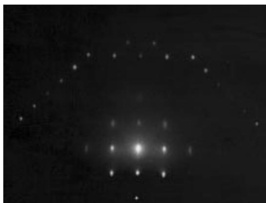
図 2:  $\text{Gd}_3\text{Ga}_5\text{O}_{12}(100)$  基板上に成長した  $\text{Fe}_3\text{O}_4(110)$  膜の RHEED 像: Azimuth= $[001]$
