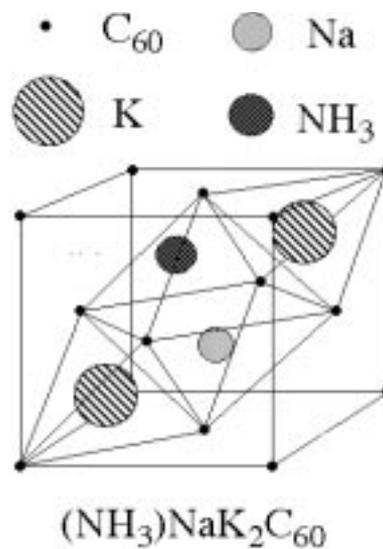
図2:(NH<sub>3</sub>)NaK<sub>2</sub>C<sub>60</sub>の結晶構造
