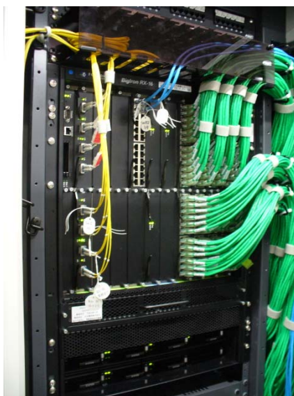
図 6.8: 実験用スイッチ C3 ( Foundry BigIron RX-16 )
