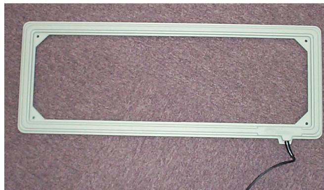
図 2.5: RFID アンテナ
