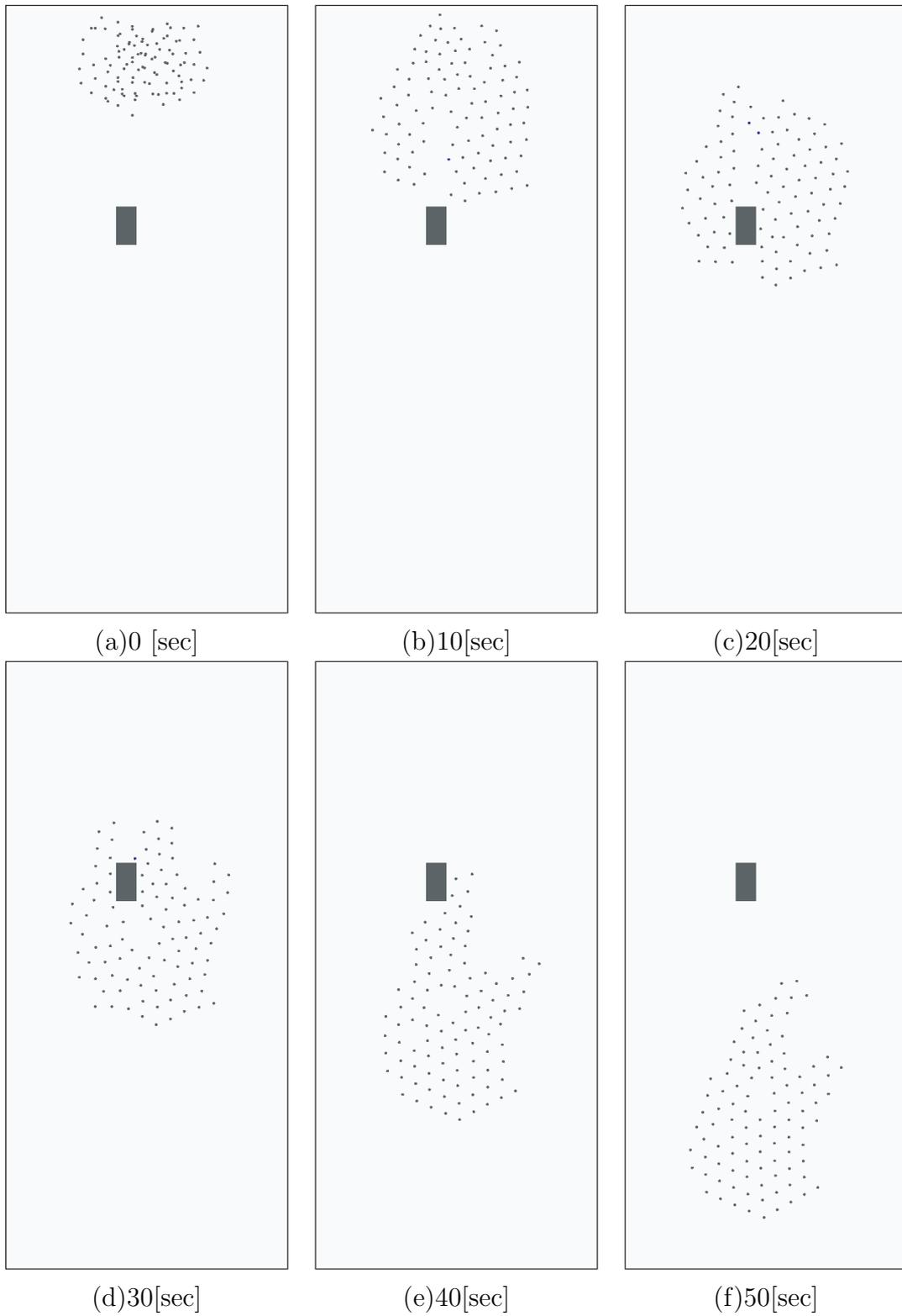
図 5.4: 単純な障害物の回避群移動
