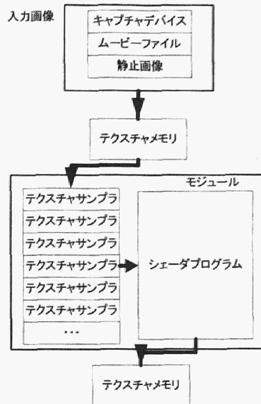
図 3. EasyGPU の処理の流れ
