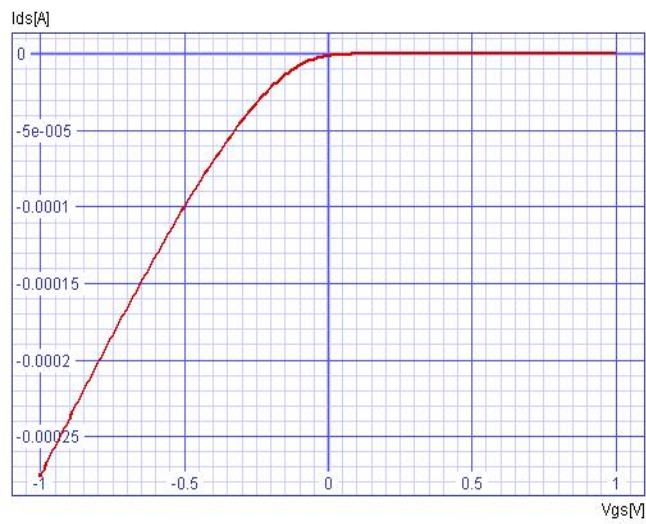
図 5.1-b pe の V_{gs} - I_{ds} 特性
