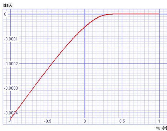
図 5.1-c pd の V_{gs} - I_{ds} 特性
