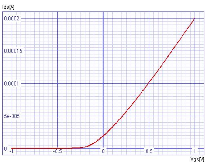
図 5.1-f nd の V_{gs} - I_{ds} 特性
