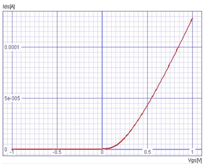
図 5.1-e ne の V_{gs} - I_{ds} 特性
