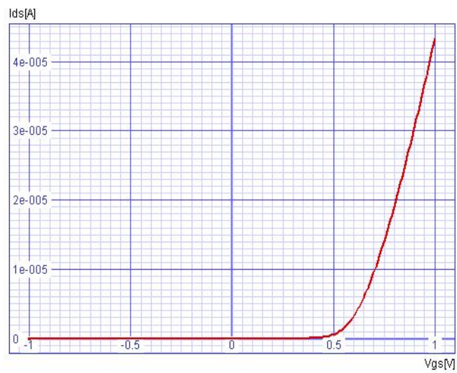
図 5.1-d NE の V_{gs} - I_{ds} 特性
