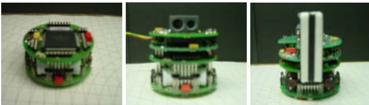
図 6.5: 自律移動ロボット Khepera (左から本体, K213 視覚モジュール搭載, リーダ機)
