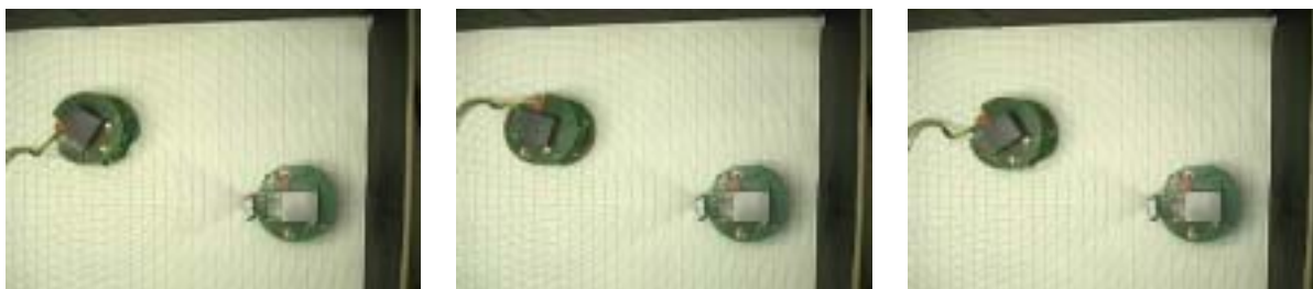
図 6.8: 実験結果 (左から探索動作 (1), 追従動作, 探索動作 (2))
