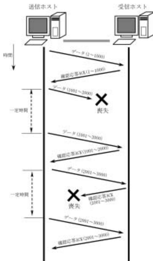
図 2.3: TCP の確認応答のしくみ
