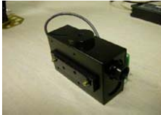
図 1.5: 赤外線 ID センサシステム
