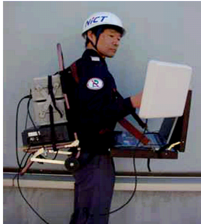
図 1.2: 無線タグを用いた非常時情報伝送システム
