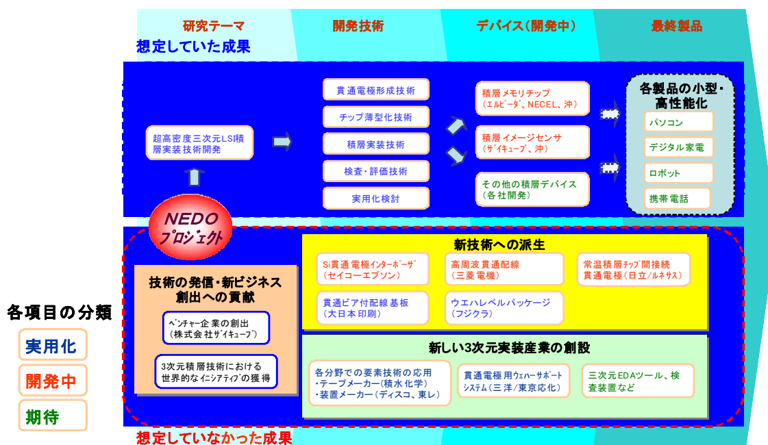
図3 「⑤超高密度電子S I技術の内、チップ積層実装技術」の成果展開フロー図
