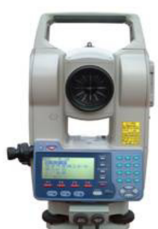
図2 クラックスケール内蔵光波測量器と作成ひび割れ図（現場で短時間に作成可能）
