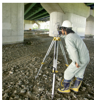
図2 クラックスケール内蔵光波測量器と作成ひび割れ図（現場で短時間に作成可能）
