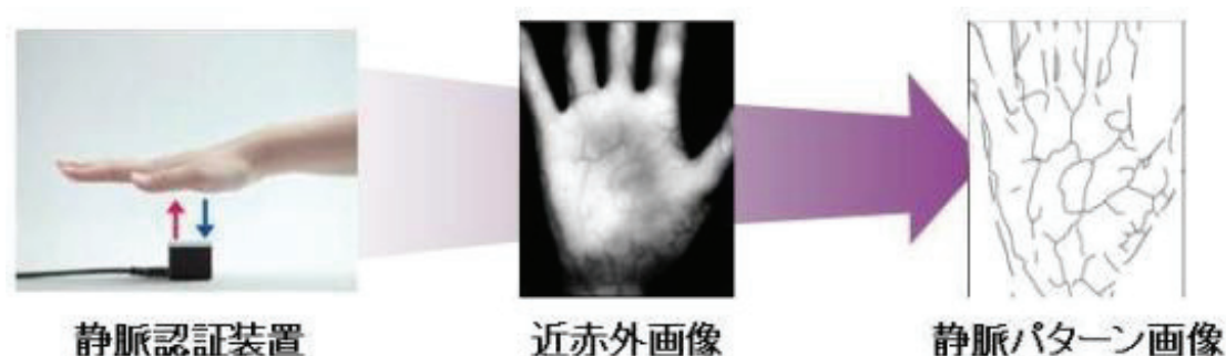
図1 非接触手のひら静脈認証技術の原理的な概要
