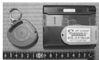
図 8 実験で捜したタグ。左が音による捜し物支援システムのタグ、右が提案システムのタグ
