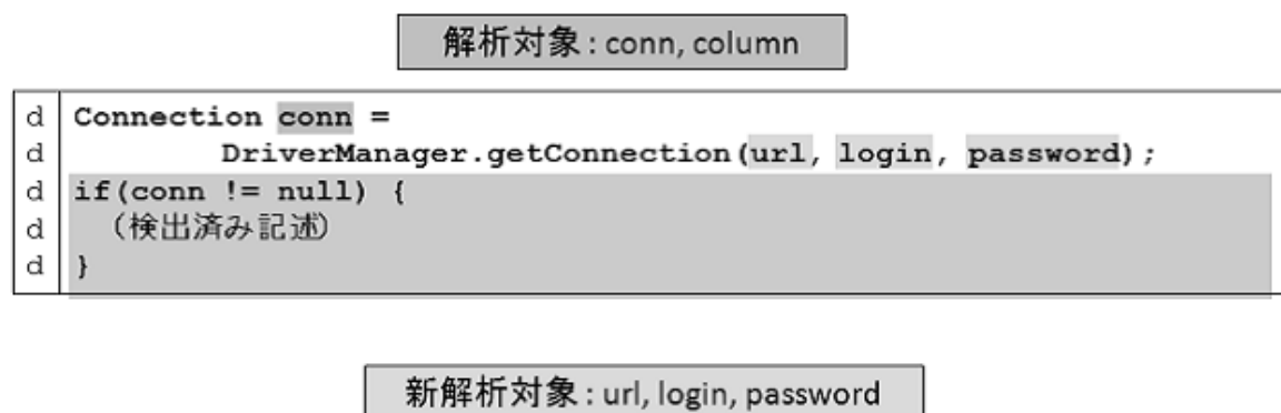
図 5.5: 代入文の右辺に出現する変数 conn, column を始点とするフロー解析
