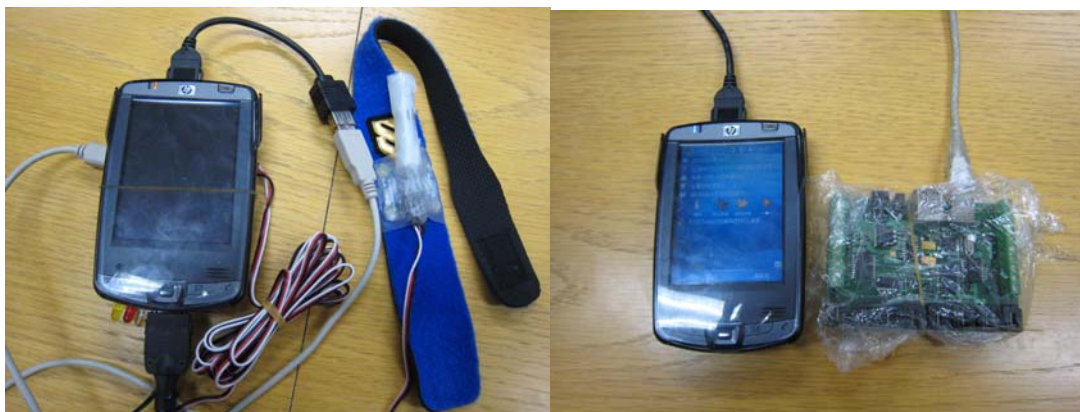
図 3.1：予備実験で使用した話し手（左）と聞き手（右）のデバイス構成
