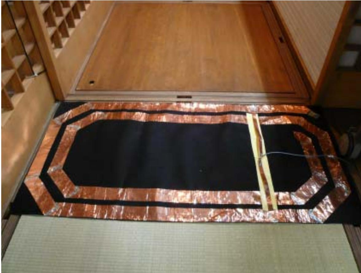
図 2.1 RFID アンテナシート
