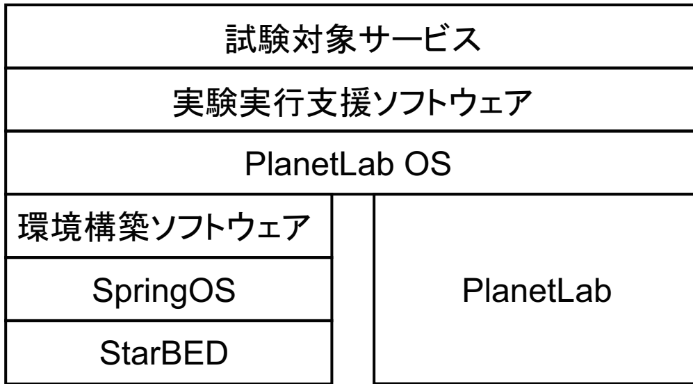
図 5.1: StarBED と PlanetLab による構成
