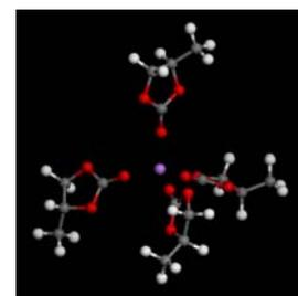
Figure 2.  $\text{Li}^+$  と PC 分子の 4 配位溶媒和構造。
