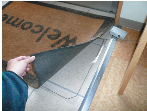
図 5 RFID アンテナ（銅線部分）とリーダ装置
