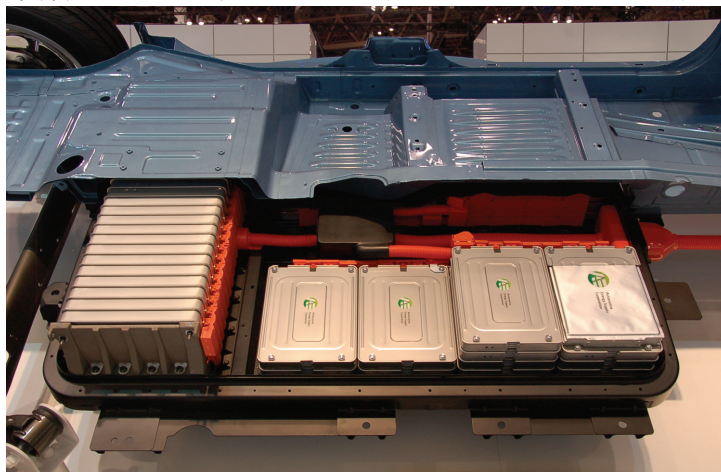
資料 2-1 リチウムイオンバッテリーのモジュール構造
