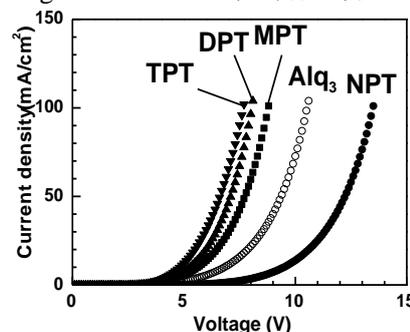
Fig. 2. 有機 EL の電流密度-電圧特性.
