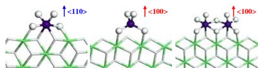
図5  $\text{MgCl}_2$ 表面上での  $\text{TiCl}_4$  の吸着構造
