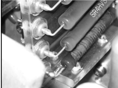
↑ 破裂した抵抗。38段、12個ずつあるうちの、これ一つの破壊が原因
